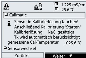
Bei der automatischen Erfassung der Cal-Temperatur misst das Messmodul die Temperatur der Kalibrierlösung mit einem Temperaturfühler (Pt 100/Pt 1000 / NTC 30 k $\Omega$  / NTC 100 k $\Omega$ ). Wenn mit automatischer Temperaturkompensation bei der Kalibrierung gearbeitet werden soll, muss ein Temperaturfühler in der Kalibrierlösung sein, der mit dem Temperatureingang am Protos verbunden ist! Wenn "Cal-Temperatur auto" parametrierung ist, erscheint "gemessene Cal-Temperatur" im Menü.
