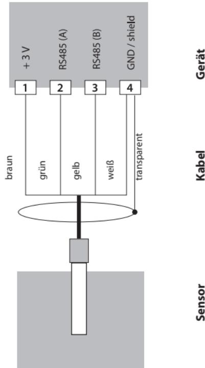
Der Sensor SE 670 wird an die RS-485-Schnittstelle des Messgerätes angeschlossen. Bei der Auswahl des Sensors SE 670 im Menü Konfiguration werden die Default-Werte als Kalibrierdaten übernommen und können anschließend durch eine Kalibrierung verändert werden.
