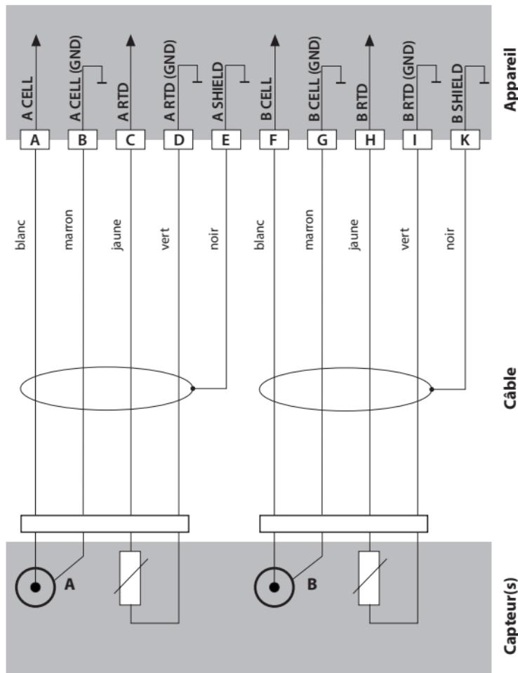
Câble de raccordement pour la transmission numérique inductive sans contact de signaux de mesure (Memosens).
