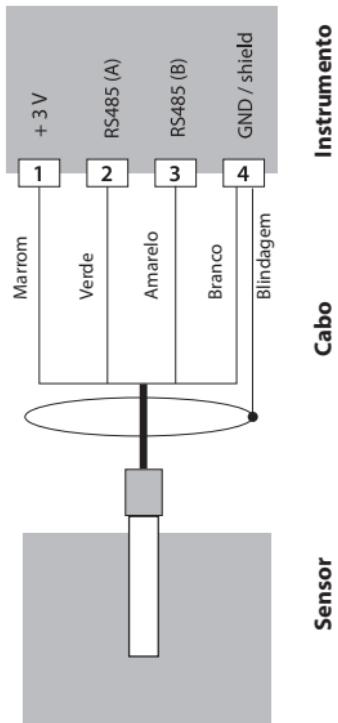
Conectar o sensor Memosens à interface RS-485 do instrumento. O sensor Memosens conectado é reconhecido automaticamente na partida do transmissor.
