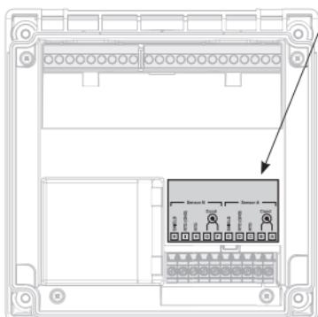
Dem Messmodul liegt ein selbstklebendes Label bei. Bringten Sie das Label auf dem Modulschacht der Gerätefront auf. Sie haben so die Beschaltung „sicher im Griff“.
