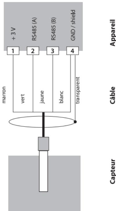
Le capteur SE 670 est raccordé à l'interface RS-485 de l'appareil de mesure. Lors de la sélection du capteur SE 670 dans le menu Configuration, les valeurs de calibrage par défaut sont automatiquement prises et peuvent ensuite être modifiées par un calibrage.
