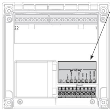
O módulo de medição vem com uma etiqueta autoadesiva. Cole-a no slot do módulo na frente do instrumento para sempre saber como são feitas as conexões.
