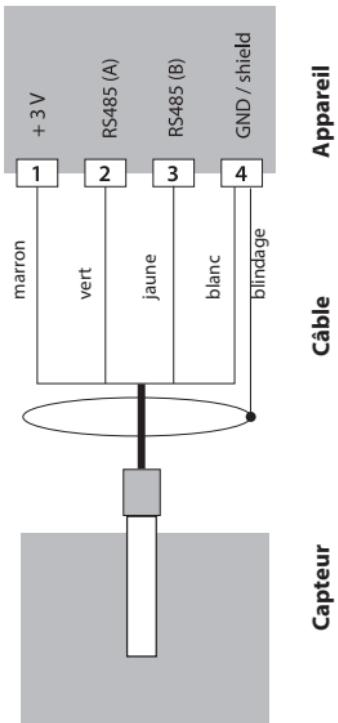
Le capteur Memosens est raccordé à l'interface RS-485 de l'appareil de mesure.
