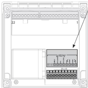
O módulo de medição vem com uma etiqueta autoadesiva. Cole a etiqueta no slot do módulo na frente do instrumento para sempre saber como são feitas as conexões.
