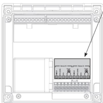
Une étiquette auto-collante est fournie avec le module de mesure. Collez l'étiquette sur la face avant de l'appareil, à l'emplacement prévu à cet effet. Ceci vous permettra d'effectuer le raccordement en toute sécurité.
