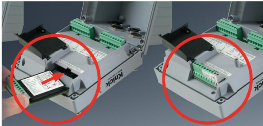
**Messmodule für den Anschluss konventioneller Sensoren
