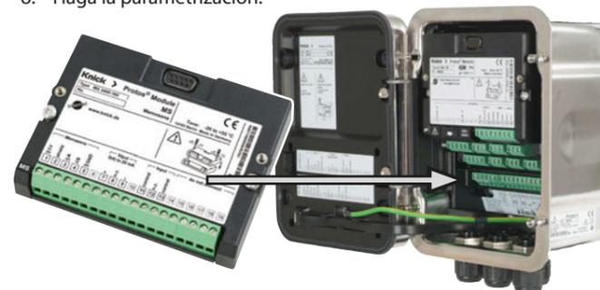
**¡PRECAUCIÓN!** Riesgo de perder la protección hermética especificada. Apriete los acoplamientos y atornille la carcasa correctamente. Observe los diámetros de cable y los pares de apriete admisibles (consulte las especificaciones de la unidad básica). Coloque tapones obturadores o insertos de sellado si es necesario.
