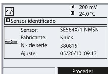
Todos los parámetros típicos del sensor se envían automáticamente al analizador. Estos son, por ejemplo, el rango de medición, el punto cero y la pendiente del sensor. Sin otra parametrización, la medición se inicia enseguida y la temperatura de medición se detecta simultáneamente.
