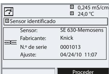
Todos los parámetros típicos del sensor se envían automáticamente al analizador. Sin otra parametrización, la medición se inicia enseguida y la temperatura de medición se detecta simultáneamente. Con «Plug&Measure» pueden utilizarse sensores Memosens premedidos para la medición inmediata sin calibración previa.
