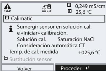
Para la detección automática de la temperatura de calibración, Protos mide la temperatura de la solución de calibración mediante el detector de temperatura integrado en el sensor.
