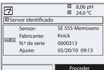
Todos los parámetros típicos del sensor se envían automáticamente al analizador.
