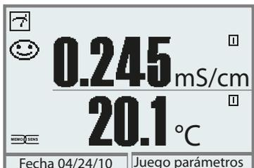
Con Protos 3400(X): el icono Memosens se muestra mientras el sensor Memosens esté conectado.
