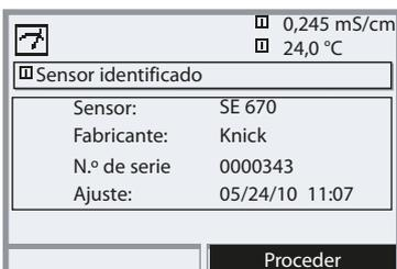
Todos los parámetros típicos del sensor se envían automáticamente al analizador. Sin otra parametrización, la medición se inicia enseguida y la temperatura de medición se detecta simultáneamente (ver también: Procedimiento TICK, siguiente página).
