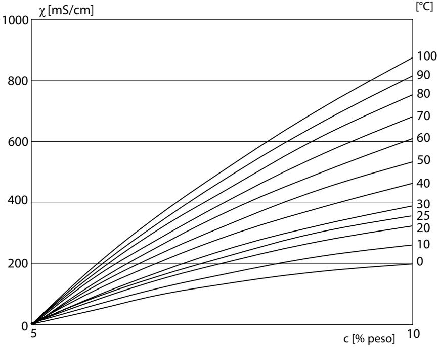
Conductividad en función de la concentración de sustancia y la temperatura del medio para la sosa cáustica (NaOH)
