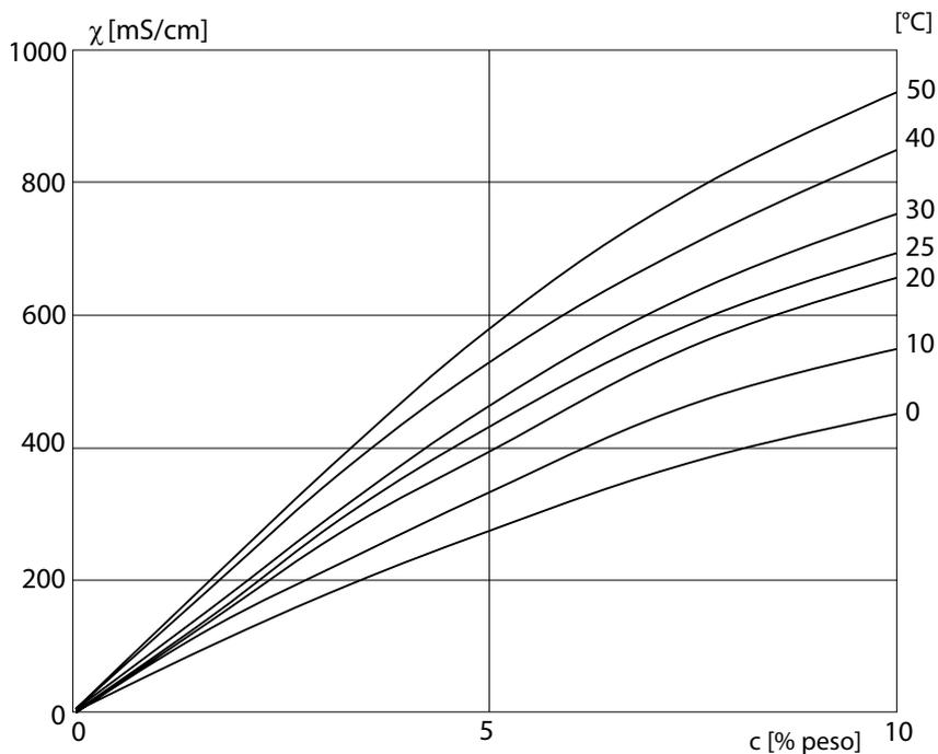
Conductividad en función de la concentración de sustancia y la temperatura del medio para ácido clorhídrico (HCl)
