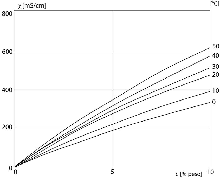
Conductividad en función de la concentración de sustancia y la temperatura del medio para ácido nítrico ( $\text{HNO}_3$ )
