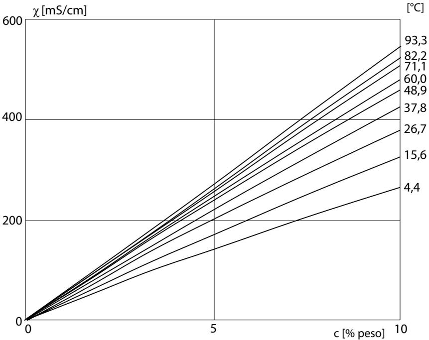
Conductividad en función de la concentración de sustancia y la temperatura del medio para ácido sulfúrico ( $H_2SO_4$ )
