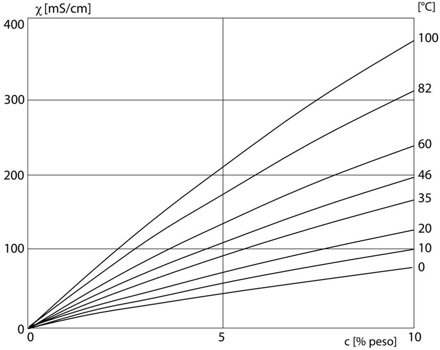
Conductividad en función de la concentración de sustancia y la temperatura del medio para la solución de cloruro sódico (NaCl)
