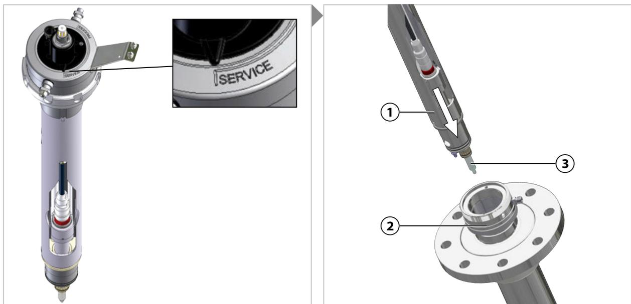
01. Es necesario asegurarse de que la unidad de accionamiento (1) se encuentre en la posición de servicio (posición final SERVICE). → *Posiciones finales SERVICE/PROCESS, p. 18*
