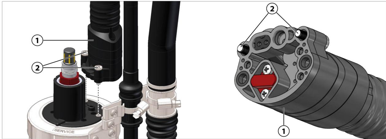
01. Comprobar que las juntas y las juntas tóricas del multiconector **(1)** se encuentren en la posición correcta y que no tengan daños. Si es necesario, reemplazarlas. → *Solución de averías, p. 40*
