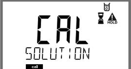
La pantalla muestra "CAL SOLUTION" en grandes caracteres. Hay un icono de reloj de arena y un triángulo con "HOLD" en la parte superior derecha. En la parte inferior izquierda hay un pequeño "cal".                                             | Preparado para la calibración.<br>El reloj de arena parpadea.                                                                                       | Pantalla (3 seg.)<br>Entonces, el dispositivo se encuentra en el modo HOLD. |
