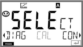
La pantalla muestra el texto "SELECT" en grandes caracteres. Debajo, se ven las opciones "DIAG", "CAL" y "CON" con flechas de navegación. En la parte superior izquierda hay un icono de sonrisa y en la superior derecha un "A".                   | Seleccione Calibración.<br>Pulse <b>enter</b> para continuar.<br>Seleccione el método de calibración CAL_SOL.<br>Pulse <b>enter</b> para continuar. |                                                                             |
