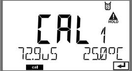
La pantalla muestra "CAL 1" en grandes caracteres. Debajo, se muestran los valores "72905" y "250°C". Hay un icono de reloj de arena y un triángulo con "HOLD" en la parte superior derecha. En la parte inferior izquierda hay un pequeño "cal". | Pulse <b>enter</b> para iniciar la calibración del primer punto de calibración.                                                                     |                                                                             |
