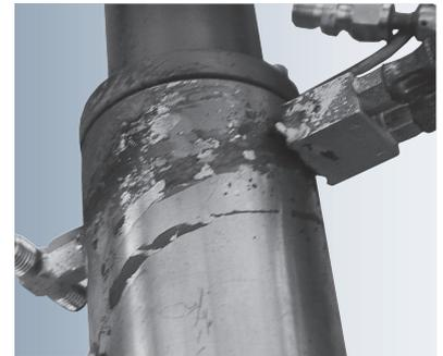
Portasondas retráctiles convencionales: un revoltijo de cables (izquierda) e incrustaciones en la mecánica de posición final desprotegida (derecha)
