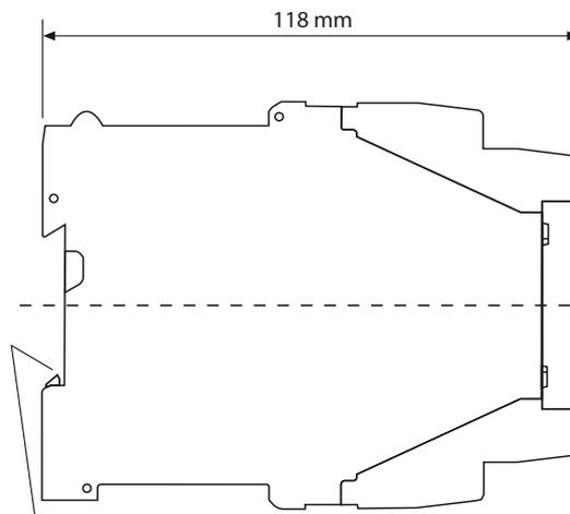
Montaje integrado en carril DIN 35 mm según EN 60715
