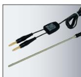
para mediciones de temperatura con tiempo de ajuste corto: Monel 2.4360, -10 ... +100 °C, clase de precisión A según DIN IEC 751
