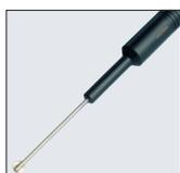
el agitador de inmersión reduce el tiempo de ajuste del sensor al medir y calibrar. En mediciones de precisión según DIN 19268, la agitación incluso está prescrita. Para evitar salpicaduras del producto de medición, el agitador se detiene inmediatamente al elevar el carro de soporte. Para la alimentación del agitador se utiliza la fuente de alimentación enchufable ZU 6956.
