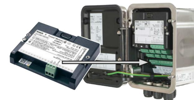
**ADVERTÊNCIA! Entrada de umidade.** O prensa-cabos tem de ficar firmemente selado. Se necessário, utilize bujões de enchimento ou insertos de vedação.
