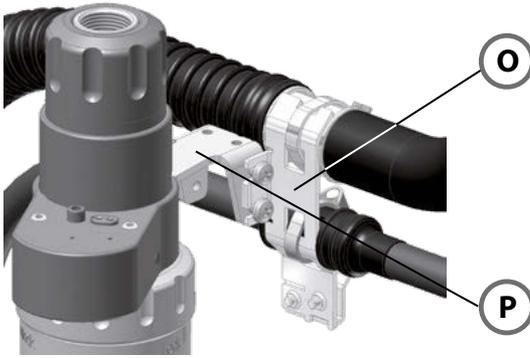
1. Vissez le collier (**O**) du raccord de milieu à la cornière de fixation (**P**) du support rétractable. Un seul sens possible est représenté ici.
