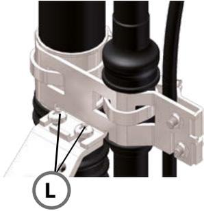
1. Fixez le collier du raccord de milieu à la cornière de fixation du Ceramat (PZ-2) en utilisant les vis de montage (**L**).
