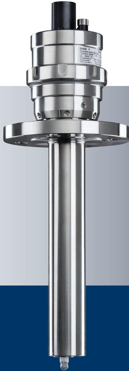
Canne d'immersion flexible ; des profondeurs d'immersion sur mesure comprises entre 150 mm et 275 mm sont possibles. Le support rétractable est conçu pour fonctionner avec des sondes électrochimiques (Ø 12 mm) d'une longueur de 425 mm ou 450 mm en cas de sondes sous pression ou de sondes optiques (Ø 12,7 mm).
