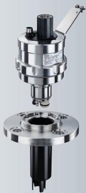
*L'entraînement est formé d'un moteur de levage et de rotation compact et pneumatique pourvu de vannes intégrées à commande forcée ; il est démontable sans interruption du process.*
