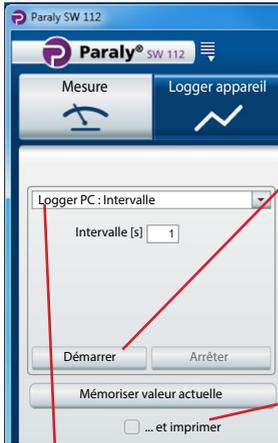
**Attention !** Les mesures commencées avec le logger PC ne sont enregistrées que sur le PC, pas dans l'appareil.
