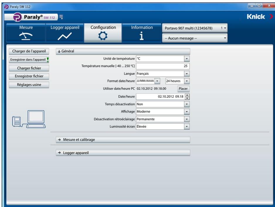
La configuration générale permet d'effectuer des réglages dans l'appareil de mesure indépendamment de l'application. Pour tous les réglages : Vous pouvez effectuer une nouvelle configuration ou choisir de modifier des données précédemment configurées dans l'appareil (« Charger de l'appareil ») ou sur votre ordinateur (« Charger fichier »).
