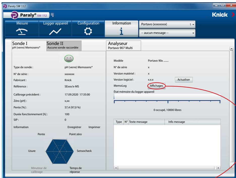
**MemoLog :** Cliquer sur le bouton « Affichages » permet d'ouvrir la fenêtre « Historique de calibrage MemoLog ».
