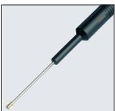
L'agitatore a immersione riduce il tempo di impostazione del sensore durante la misurazione e la calibrazione. Nelle misurazioni di precisione a norma DIN 19268, l'agitazione è prevista dalla norma stessa. Per evitare schizzi del materiale sottoposto a misurazione, l'agitatore si arresta immediatamente al sollevamento del carrello dello stativo. L'alimentazione dell'agitatore è fornita dall'alimentatore a spina ZU 6956.
