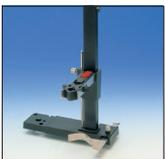
Oltre all'agitatore a immersione, lo stativo è in grado di alloggiare fino a tre sonde di misura di qualsiasi tipo. Gli arresti regolabili impediscono il danneggiamento del sensore e del vetro del bicchiere. Viene meno anche la laboriosa regolazione in fase di cambio del campione. Una canalina portacavi integrata elimina eventuali grovigli di cavi sul banco da laboratorio. Per l'agitatore a immersione modello ZU 6955 e tre sensori di qualsiasi tipo. Fissaggio direttamente al dispositivo.
