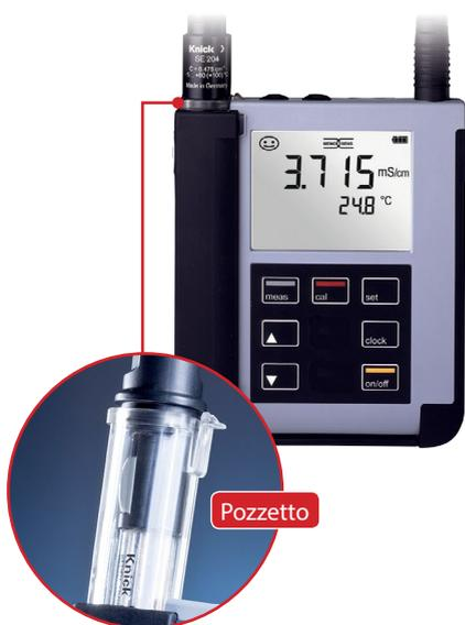
**Portavo 902 COND** è un apparecchio portatile per la misurazione della conduttività. Il comando è molto intuitivo grazie ad una riga di testo chiaro in un display LCD pieno di contrasto.
