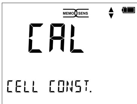
Calibrazione (mediante immissione della costante di cella)
