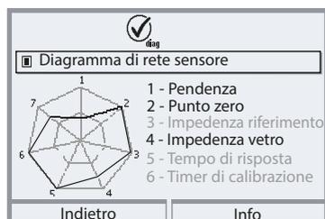
Esempio: diagramma di rete di un sensore pH digitale (Memosens)
