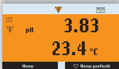
ARANCIONE: NE 107 Messaggio di stato "Controllo funzionamento"
