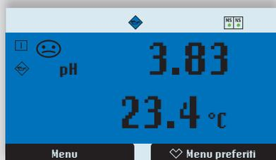
BLU: NE 107 Messaggio di stato "Manutenzione necessaria"
