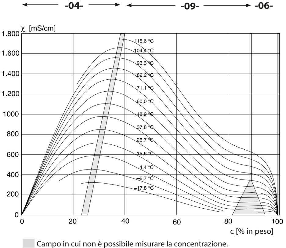
Conducibilità in funzione della concentrazione di sostanza e della temperatura dei mezzi per l'acido solforico ( $H_2SO_4$ )
