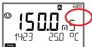
In caso contrario viene emesso un messaggio di errore. Il simbolo **info** viene visualizzato, con i tasti freccia ◀ ▶ è possibile leggere il testo dell'errore nella riga inferiore. Sensoface è triste (vd. elenco dei messaggi di errore e Sensoface nel supplemento):
