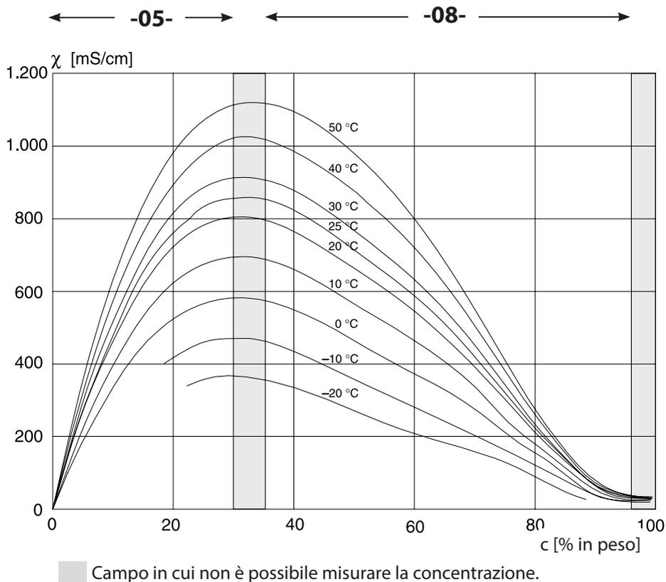
Conducibilità in funzione della concentrazione di sostanza e della temperatura dei mezzi per l'acido nitrico ( $\text{HNO}_3$ )
