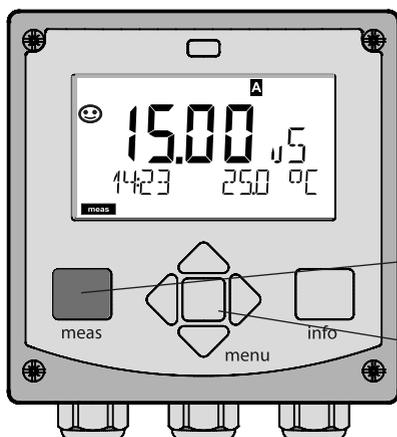
Come MAIN DISPLAY viene indicata in modalità di misurazione la visualizzazione attiva. La modalità di misurazione si apre da altre modalità operative premendo a lungo il tasto **meas** (> 2 s).
