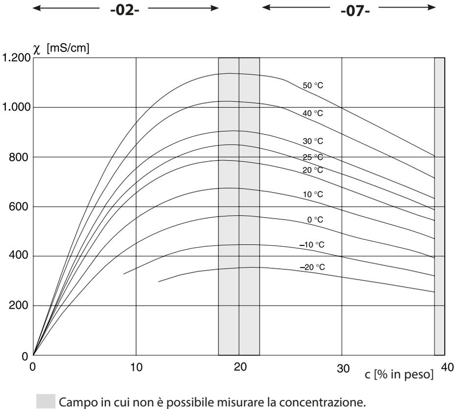
Conducibilità in funzione della concentrazione di sostanza e della temperatura dei mezzi per l'acido cloridrico (HCl)
