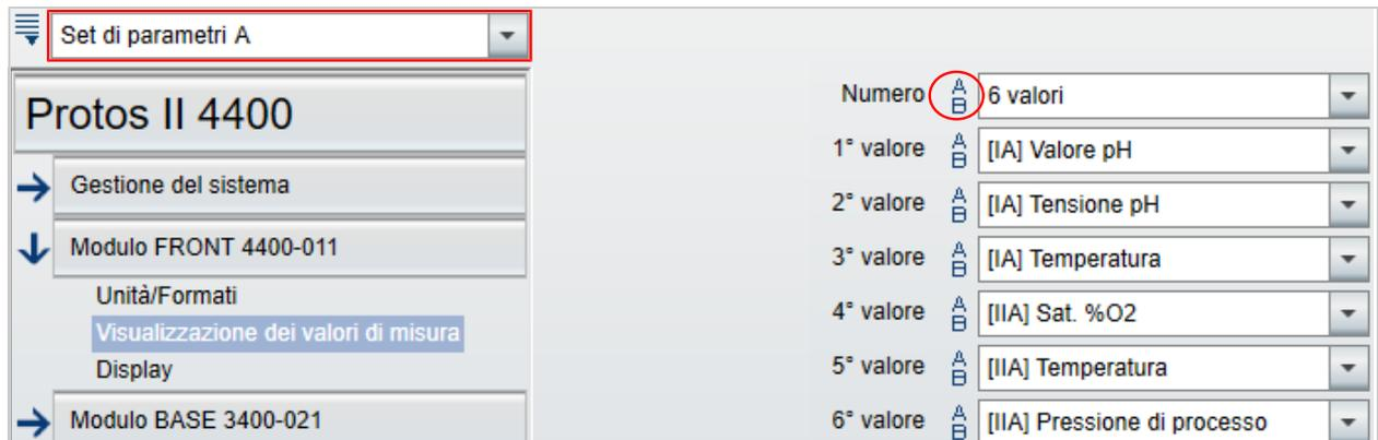
La marcatura A/B davanti a ogni valore indica che questo parametro può essere impostato per diversi set di parametri. I set di parametri A e B sono disponibili per la selezione. → *Set parametri A/B, P. 8*
