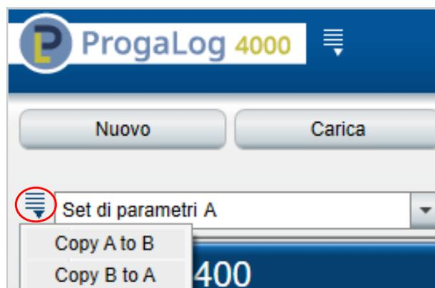
L'intero set di parametri A può essere copiato nel set di parametri B e viceversa. Ciò dovrebbe facilitare la parametrizzazione dell'altro set di parametri, poiché tutte le impostazioni possono essere adottate e regolate più facilmente.
