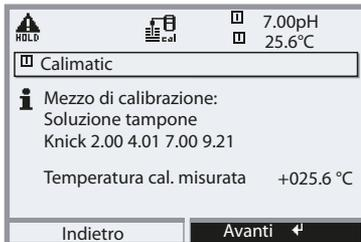
Protos misura la temperatura della soluzione tampone con la sonda di temperatura integrata nel sensore Memosens.
