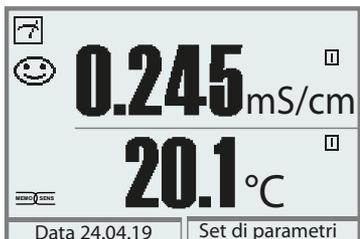
Tutti i parametri tipici del sensore vengono trasmessi automaticamente al misuratore.
