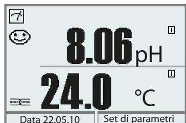
Con Protos 3400(X): Sul display appare il simbolo Memosens finché è collegato un sensore Memosens.
