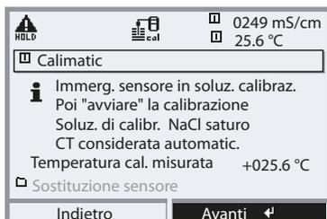
Con il rilevamento automatico della temperatura cal., Protos misura la temperatura della soluzione di calibrazione con la sonda di temperatura integrata nel sensore.
