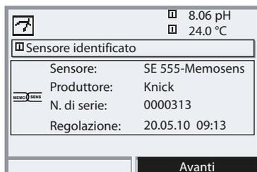
Tutti i parametri tipici del sensore vengono trasmessi automaticamente al misuratore. Ciò riguarda, ad esempio, il campo di misura, il punto zero e la pendenza del sensore. Le misurazioni vengono eseguite immediatamente senza ulteriore parametrizzazione, la temperatura di misurazione viene registrata simultaneamente. I sensori Memosens premisurati possono essere messi in funzione immediatamente tramite "Plug&Measure" senza calibrazione sul dispositivo.
