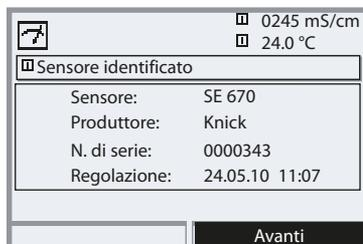
Tutti i parametri tipici del sensore vengono trasmessi automaticamente al misuratore. Le misurazioni vengono eseguite immediatamente senza ulteriore parametrizzazione, la temperatura di misurazione viene registrata simultaneamente (vedere anche: procedura TICK, pagina seguente).
