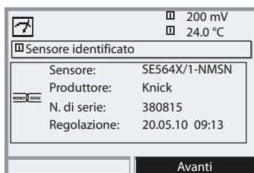
Tutti i parametri tipici del sensore vengono trasmessi automaticamente all'apparecchio di misurazione.
