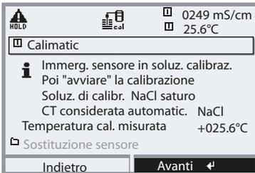
Con il rilevamento automatico della temperatura cal., Protos misura la temperatura della soluzione di calibrazione con la sonda di temperatura integrata nel sensore Memosens.
