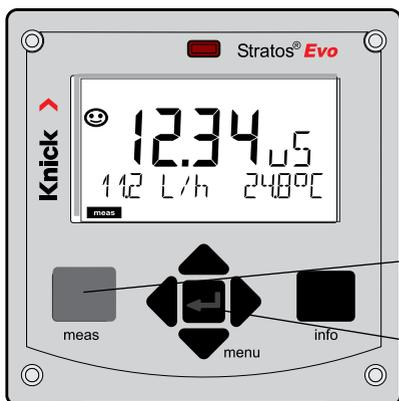
Con MAIN DISPLAY viene indicata in modalità di misurazione la visualizzazione attiva. La modalità di misurazione si apre da altre modalità operative premendo a lungo il tasto **meas** (> 2 s).
