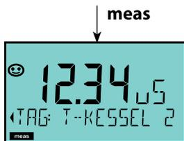
Se si preme brevemente **meas**, si aprono altre schermate del display, ad esempio Denominazione stazione di misurazione (TAG) o Portata (l/h). Queste hanno una retroilluminazione turchese e passano dopo 60 s al display principale.
