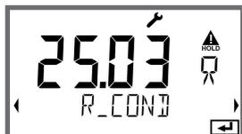
Capacità residua dello scambiatore di ioni
