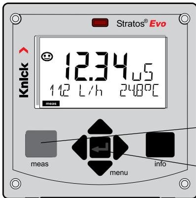
Come MAIN DISPLAY viene indicata in modalità di misurazione la visualizzazione attiva. La modalità di misurazione si apre da altre modalità operative premendo a lungo il tasto **meas** (> 2 s).
