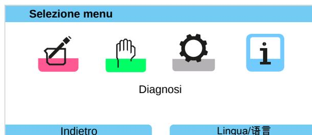
Le funzioni di diagnosi possono essere richiamate direttamente dalla modalità di misurazione tramite la **softkey** destra. Allo scopo alla **softkey** destra (**1**) deve essere assegnata la funzione **Menu preferiti** : **Parametrizzazione** ▶ **Gestione del sistema** ▶ **Gestione delle funzioni** → *Gestione delle funzioni, p. 45*
