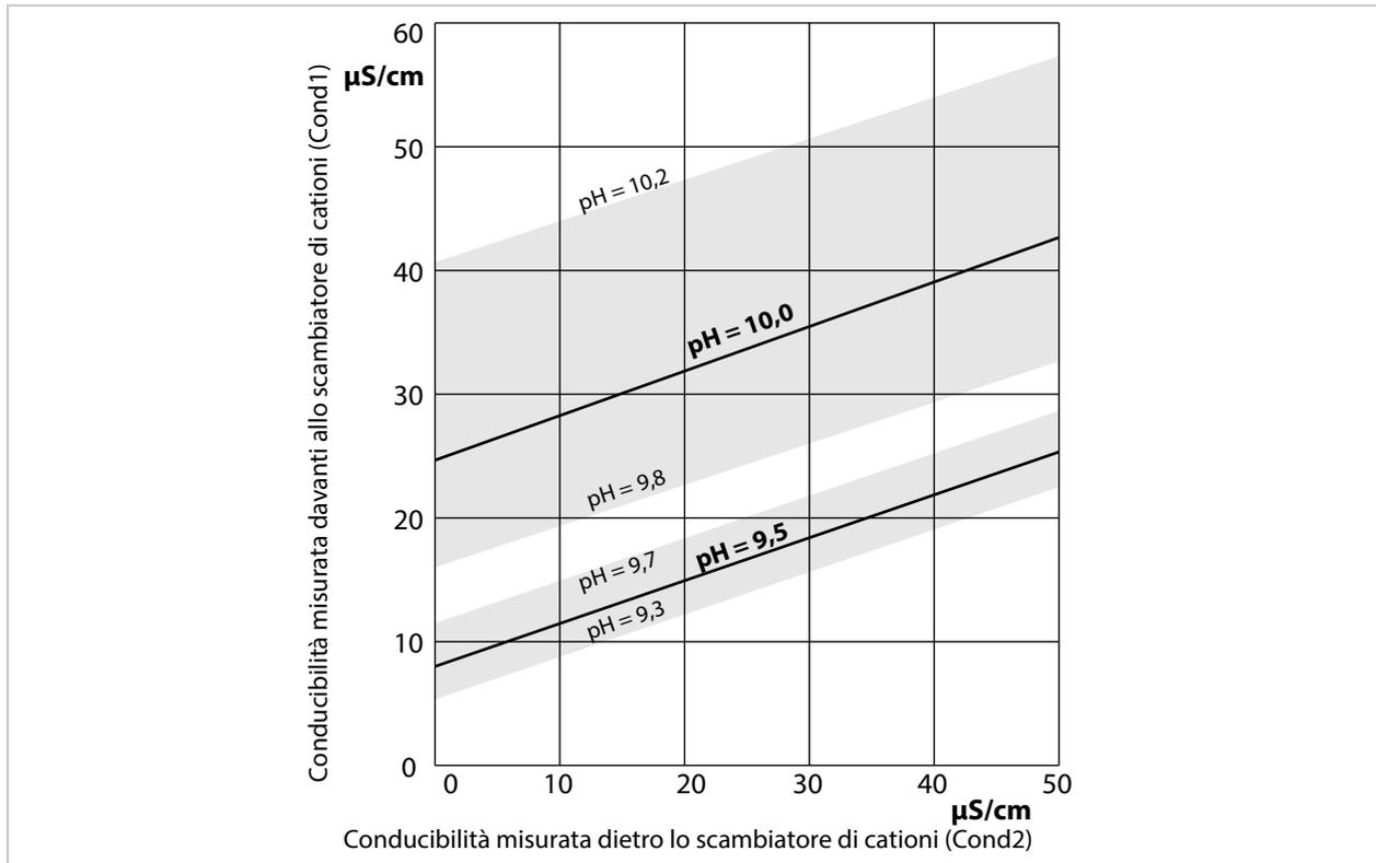
Condizionamento dell'acqua delle caldaie a circolazione naturale con idrossido di sodio. Relazione tra il valore pH e la conducibilità misurata a monte e a valle dello scambiatore di cationi.
