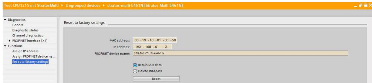
La funzione di reset tramite PROFINET non ripristina le impostazioni di default di Stratos Multi.
