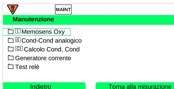
Il menu Manutenzione offre diverse funzioni per il controllo del funzionamento del dispositivo:
