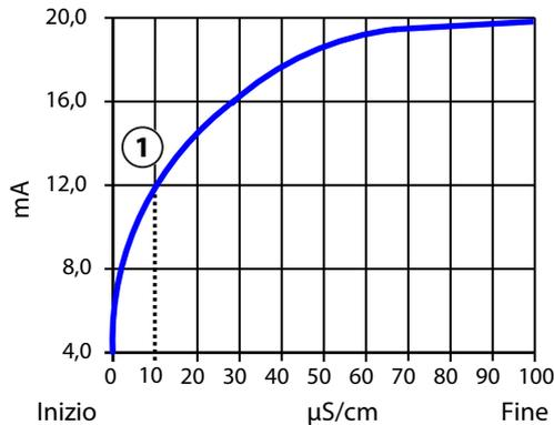
Uscita 4 ... 20 mA, intervallo di misura 1 ... 1000  $\mu\text{S/cm}$
