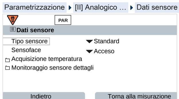
01. In **Acquisizione temperatura** selezionare la sonda di temperatura utilizzata e se la temperatura durante la misurazione e/o la calibrazione deve essere misurata automaticamente o a mano.
