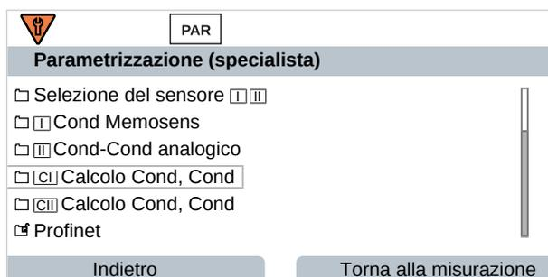
05. Effettuare la parametrizzazione del blocco di calcolo.
