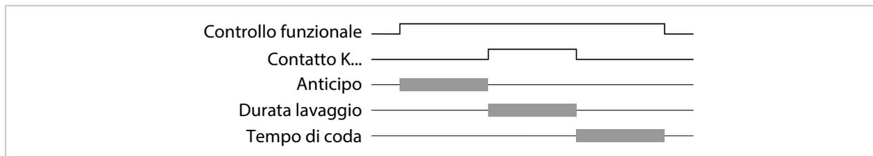
**Nota:** Il controllo funzionale (HOLD) è attivato dall'inizio dell'anticipo fino alla fine del tempo di coda. Le uscite di corrente e i contatti di commutazione rimanenti si comportano in base alla parametrizzazione.
