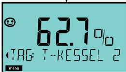
Se si preme brevemente **meas**, si aprono altre schermate del display, ad esempio Denominazione stazione di misurazione (TAG) o Portata (l/h). Queste hanno una retroilluminazione turche- se e passano dopo 60 s al display principale.
