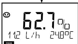
Se si preme brevemente **meas**, si aprono altre schermate del display, ad esempio Denominazione stazione di misurazione (TAG) o Portata (L/h). Queste hanno una retroilluminazione turchese e passano dopo 60 s al display principale.
