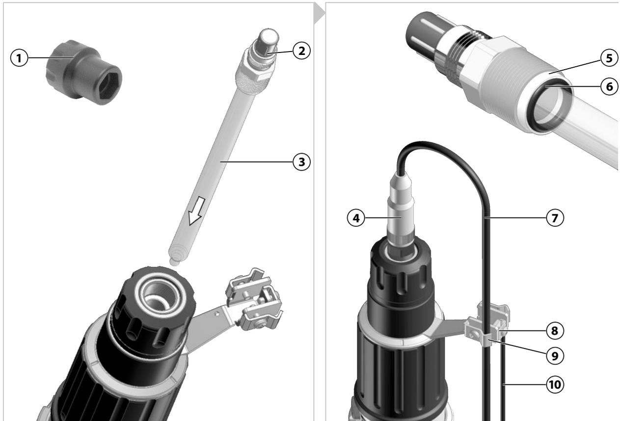
01. SensoGate WA131MH을(를) 서비스 위치(SERVICE 정위치)로 이동합니다. → *서비스 위치(SERVICE 정위치)로 이동, p. 26*
