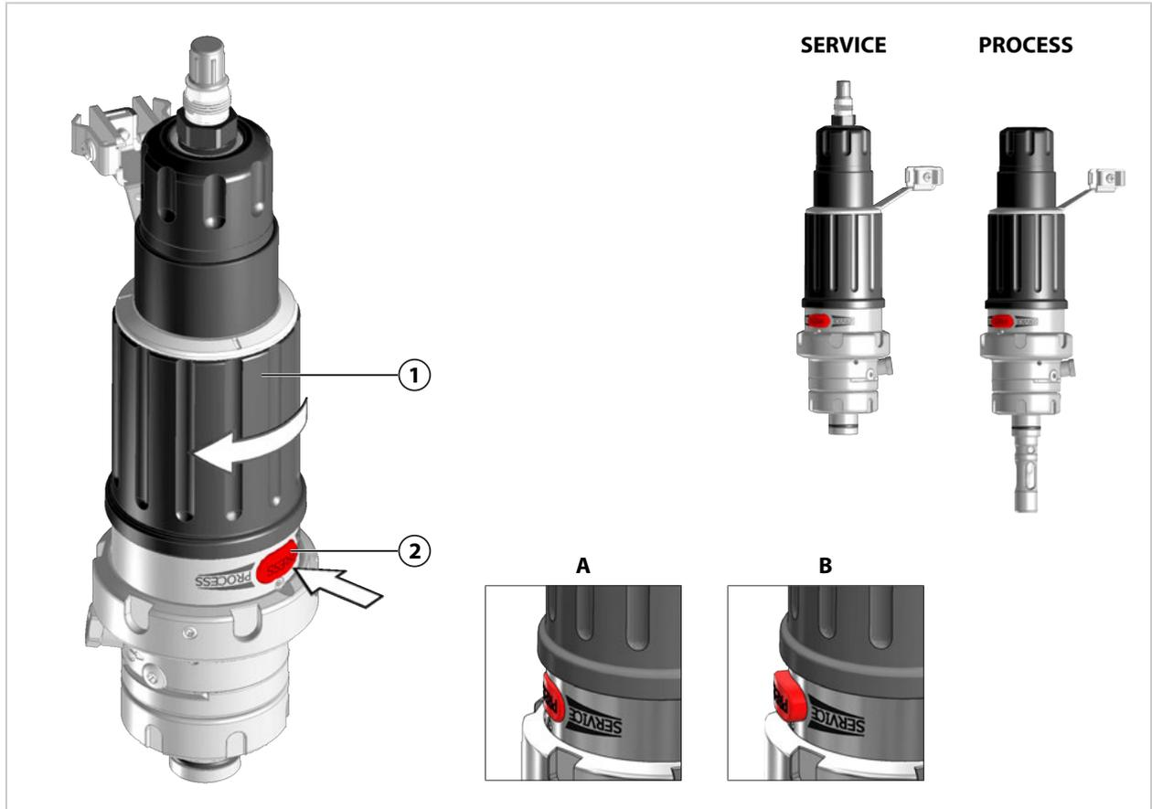
01. 센서를 모니터링합니다. → *센서 장착 및 탈거, p. 27*
