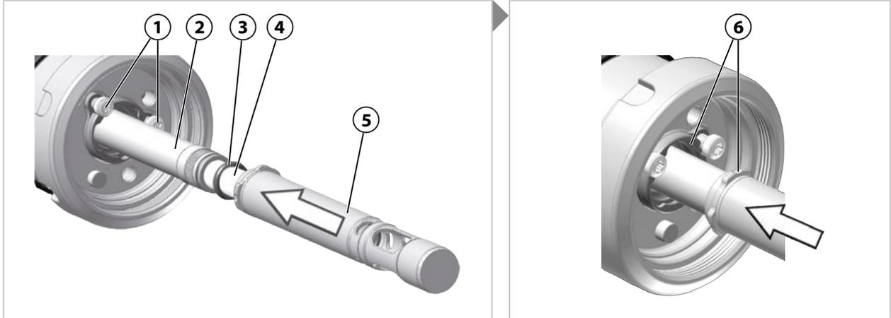
01. 센서를 설치합니다. → *센서 장착 및 탈거, p. 27*
