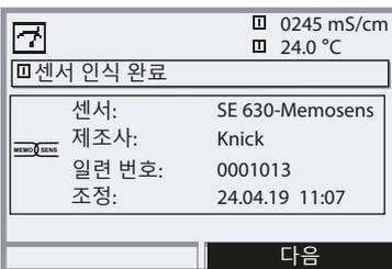
센서의 모든 일반적인 파라미터가 측정 기기로 자동 전송됩니다. 추가 파라미터 설정 없이 측정이 즉시 수행되는 동시에 측정 온도가 기록됩니다. 미리 측정된 Memosens 센서는 기기에서 교정 없이 "Plug & Measure(연결 및 측정)"를 통해 즉시 작동할 수 있습니다.
