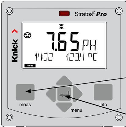
메인 디스플레이(Main Display)는 측정 모드에서 활성화된 표시 값을 뜻합니다. 다른 작동 모드에서 측정 모드로 전환하기 위해서는 **meas**키를 2초 이상 누르면 됩니다.
