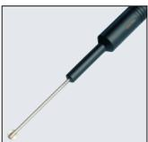
浸入式搅拌器有助于在测量和校准时缩短传感器的响应时间。在根据 DIN 19268 进行精密测量时, 甚至必须要进行搅拌。搅拌器在提升支架滑块时立即停止, 以防止被测物料飞溅。电源适配器 ZU 6956 用于给搅拌器供电。
