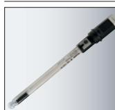
玻璃杆, 陶瓷隔膜, 长度 170 mm
