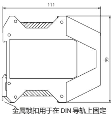
• H1 结构：带插入式螺纹端子
